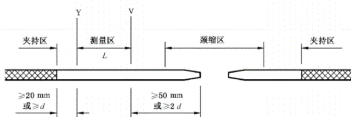
图 A.1 断裂后的测量
